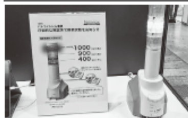
▲ランプの点灯で異常通知
