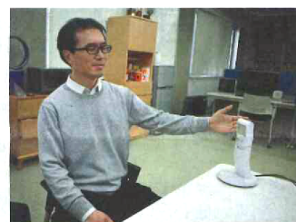
阪本准教授らが開発したミリ波センサーは、扇風機など動く物が周囲にあっても測定に問題がない
