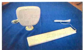
青森市で高齢者の見守りに使われるセンサー。天井に設置するタイプ(左奥)とベッド下に置くタイプがある
